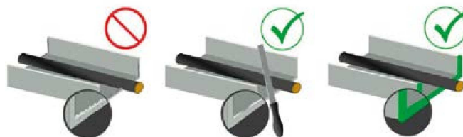
Rys. 3: Należy stosować ochronę krawędzi lub dodatkowo zabezpieczoną instalację w plastikowych rurach w obszarze krawędzi i ugięć przewodów
