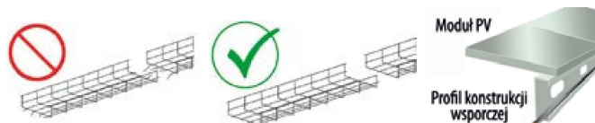
Rys. 4: Kratka kablowa z wolnymi końcami prętów i ostrymi krawędziami. Uwaga – niebezpieczeństwo uszkodzenia izolacji!
